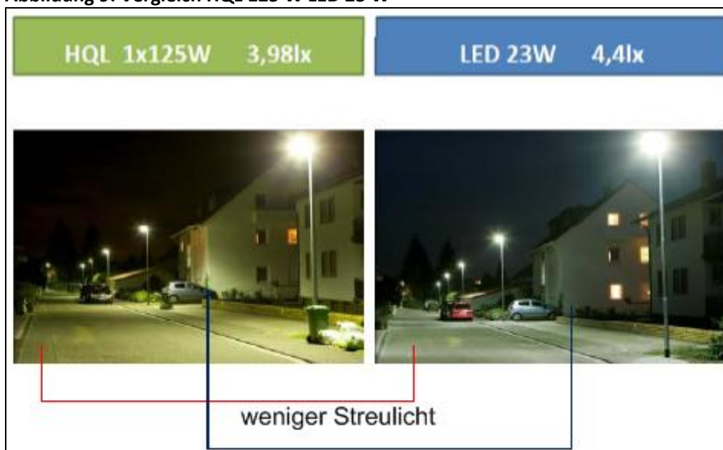
Abbildung 9: Vergleich HQL 125 W LED 23 W
